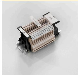
Групповые держатели шильдиков SchT 5 S крепятся непосредственно на монтажную рейку TS 32 (G-образная рейка) или TS 35 (рейка цилиндровой формы). Поэтому клеммные колодки можно маркировать вне зависимости от клемм и типа клемм. SchT 5 и SchT 5 S оснащены защитными полосками ESO 5, STR 5.
