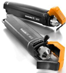
Инструменты для удаления оболочки кабеля с ПВХ-изоляцией
