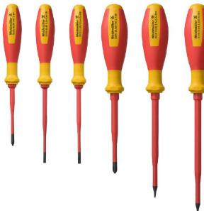
Отвертка, изолированная согласно VDE, для работ на деталях, находящихся под напряжением до 1000 В AC и 1500 В DC, DIN EN 60900, IEC 900. Безопасность проверена - "GS", поштучный контроль. Лезвие из высоколегированной хромомолибденованадиевой стали, закаленное по всему объему, вороненое.
