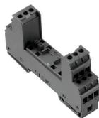
Базовый элемент для втычных разрядников VSPC, Встроенная PE в цоколе VSPC BASE, не изменяющем импеданс, а также соединение PE (FG) с плавающим заземлением через интегрированный искровой промежуток надежно отводит до 20 кА (8/20 мкс) и 2,5 кА (10/350 мкс) на защитный провод PE.
