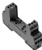
Базовый элемент для вставных разрядников VSPC. Встроенный в основание вывод защитного заземления (PE) импеданс-нейтрального VSPC BASE и соединение плавающего заземления PE (FG) через встроенный искровой промежуток, безопасная разрядка токов до 20 кА (8/20 мкс) и 2,5 кА (10/350 мкс) на землю. Подходит для незаземленных сигнальных цепей.
