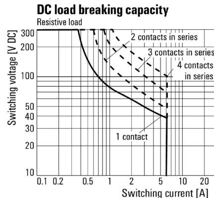
Кривая предельной нагрузки
