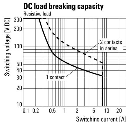
Кривая предельной нагрузки
