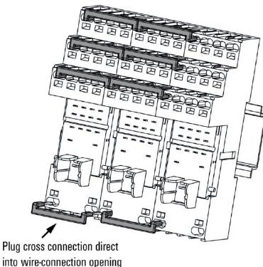
Вставьте перемычки в кабельные соединения
