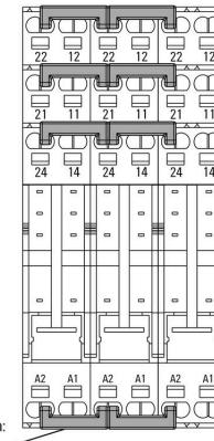
Перемычка замыкается с таким же соединением на соседнем основании
