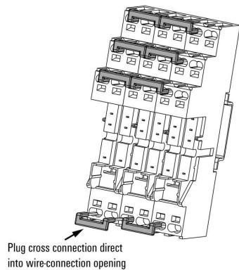
Вставьте перемычки в кабельные соединения
