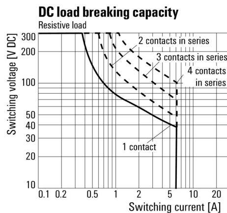
Кривая предельной нагрузки
