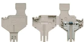
Компонентный штекер служит для интеграции электрического компонента в расцепляющий клеммный блок. После пайки электронного компонента вставку можно интегрировать в расцепляющую зону расцепляющих клеммных блоков, тем самым преобразуя расцепляющий клеммный блок в модульный клеммный блок с интегрированным электронным компонентом.
