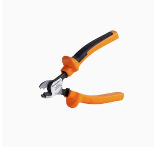
Режущие инструменты для проводников наружным диаметром до 8, 12, 14 и 22 мм. Особая геометрия лезвия обеспечивает резку медных и алюминиевых проводников без пережата и с минимальным физическим усилием. Режущие инструменты (от KT 8 до KT 22) также поставляются с защитной изоляцией до 1000 В, прошедшей испытания VDE и GS, в соответствии со стандартом EN/ IEC 60900.
