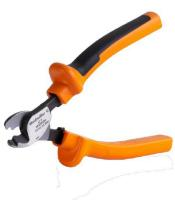
Режущие инструменты для проводников наружным диаметром до 8, 12, 14 и 22 мм. Особая геометрия лезвия обеспечивает резку медных и алюминиевых проводников без перекатия и с минимальным физическим усилием. Режущие инструменты (от KT 8 до KT 22) также поставляются с защитной изоляцией до 1000 В, прошедшей испытания VDE и GS, в соответствии со стандартом EN/ IEC 60900.
