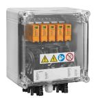
Соединительные коробки PV Next для инверторов постоянного тока с 1-12 трекерами MPP используются для защиты стороны постоянного тока фотоэлектрической системы. Соединительные коробки защищают инвертор от избыточного напряжения и соответствуют Европейской директиве CLC/TS 51643-32. Кроме того, эти изделия способны защитить систему от обратных токов и обеспечивают возможность комбинировать жилы для экономии использования кабелей при монтаже.
