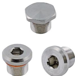
Заглушки серии VP предлагают способ заполнения неиспользуемых кабельных вводов в оборудовании, предназначенном для взрывоопасных зон, вместе с тем обеспечивая огнестойкость класса Ex d и повышенную взрывозащиту класса Ex e, а также класс защиты от проникновения загрязнений IP66/67/68.
