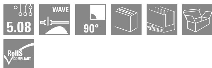
Семейство штекерных соединителей SLEH, изначально разработанное для корпусов электронных приборов, также подходит для универсального применения в качестве интерфейса для гнездовых разъемов. Двойной изгиб штырьков обеспечивает особую ориентацию штекерного соединителя на печатной плате: он располагается вертикально. Кроме того, длина выводов под пайку оптимизирована для пайки волной припоя.
