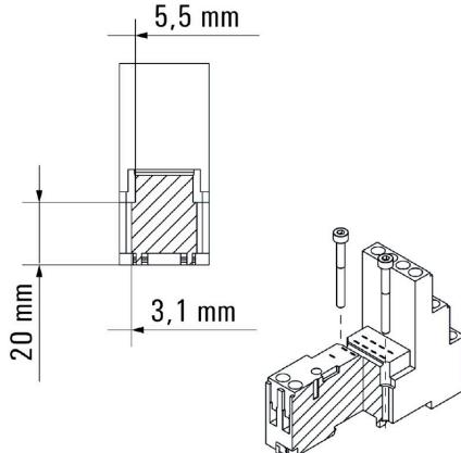
Как установить маркировочный элемент на гнезда
