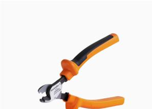
Режущие инструменты для проводников наружным диаметром до 8, 12, 14 и 22 мм. Особая геометрия лезвия обеспечивает резку медных и алюминиевых проводников без пережата и с минимальным физическим усилием. Режущие инструменты (от КТ 8 до КТ 22) также поставляются с защитной изоляцией до 1000 В, прошедшей испытания VDE и GS, в соответствии со стандартом EN/ IEC 60900.
