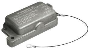
Возможность разделения кабелей в зоне 2 в соответствии со следующими допусками к эксплуатации ATEX: T II 3G Ex ec IIC T6 Gc или IECEx: Ex ec IIC T6 Gc упрощает монтаж, обслуживание и повышает качество подготовки. Предлагаемые одобренные соединители всегда должны использоваться в комплекте с соответствующими одобренными корпусами и вставками и могут быть отключены только без нагрузки.
