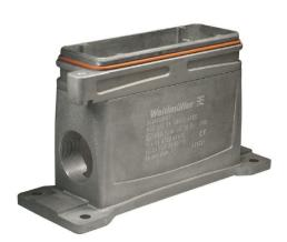
Возможность разделения кабелей в зоне 2 в соответствии со следующими допусками к эксплуатации АТЕХ: Т II 3G Ex ес IIC T6 Gc или IECEX: Ex ес IIC T6 Gc упрощает монтаж, обслуживание и повышает качество подготовки. Предлагаемые одобренные соединители всегда должны использоваться в комплекте с соответствующими одобренными корпусами и вставками и могут быть отключены только без нагрузки.
