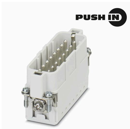
Технология соединения PUSH IN — это технология с прямым штекерным соединением. Предварительно обработанный проводник можно вставить непосредственно на уровне подключения проводника без дополнительных вспомогательных средств.
