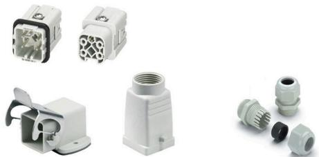
Комплекты HDC – это стандартизированные наборы для изготовления соединительного разъема в сборе. Комплекты HDC, как правило, состоят из вилочной вставки, розеточной вставки, корпуса вилки, проходного корпуса и кабельного ввода.
