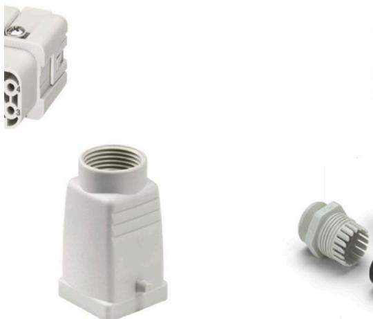
Комплекты HDC – это стандартизованные наборы для изготовления соединительного разъема в сборе. Комплекты HDC, как правило, состоят из вилочной вставки, розеточной вставки, корпуса вилки, проходного корпуса и кабельного ввода. Weidmüller предлагает набор для всех востребованных комбинаций соединительных разъемов с метрическими кабельными вводами или с вводами с резьбой PG.
