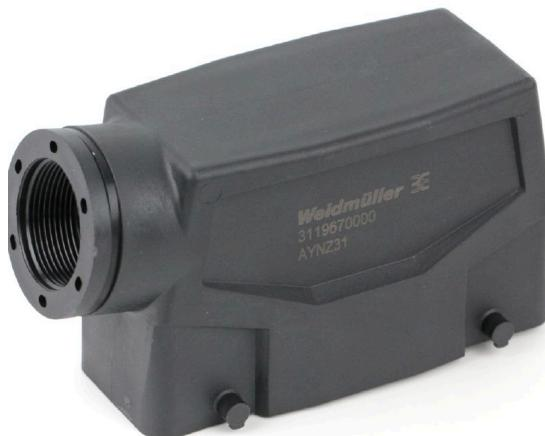
Пластиковые корпуса особенно подходят для применения в сферах, где стойкость металлов недостаточна. Кроме того, указанные здесь корпуса легче и немного дешевле, чем стандартные алюминиевые корпуса. Поэтому использование пластиковых корпусов в сферах применения, где не требуется такая же прочность материалов, может быть целесообразно. Герметичность по-прежнему соответствует классу IP65.
