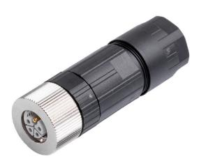
Вашим периферийным устройствам требуется питание большей мощности. С нашим новым вставным разъемом M12 можно обеспечить питание более 250 В и 2 А без всяких проблем. Компактные штекерные разъемы M12 с A-, K-, L-, S- и Т-кодировкой предназначены для передачи напряжения до 630 В перем. тока или 60 В пост. тока и 12 A.
