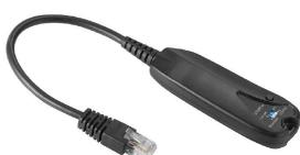
Модуль для сохранения и загрузки конфигурации устройств
