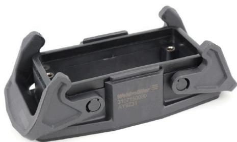
Пластиковые корпуса особенно подходят для применения в сферах, где стойкость металлов недостаточна. Кроме того, указанные здесь корпуса легче и немного дешевле, чем стандартные алюминиевые корпуса. Поэтому использование пластиковых корпусов в сферах применения, где не требуется такая же прочность материалов, может быть целесообразно. Герметичность по-прежнему соответствует классу IP65.
