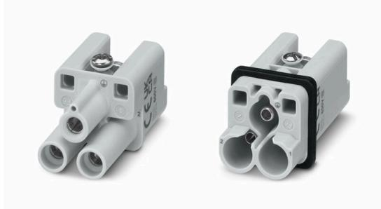
Серия HQ — широкие возможности в компактной конструкции. Электрические характеристики говорят сами за себя. Подключение проводника рассчитано на осевой винт. Эта технология обеспечивает подключение проводника без специальных инструментов. Достаточно простого шестигранного ключа.
