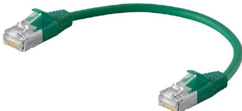
Собранные кабели с 2x RJ45, подходящие для интеллектуальных измерительных задач, различных цветов в соответствии с DIN VDE 0603-100. Короткие вилки и кабели с небольшим радиусом изгиба для тесных пространств и корпус для вилки с изоляцией по периметру обеспечивают класс защиты IP30 при сопряжении.
