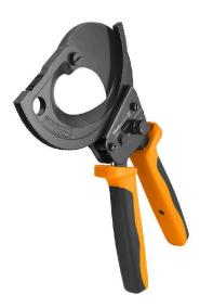
Режущие инструменты в исполнении с храповым механизмом. Подходит для резки без смятия медных и алюминиевых проводов. Малое усилие на рукоятке благодаря оптимальному передаточному отношению рычага и технически усовершенствованному эксцентриковому приводу.
