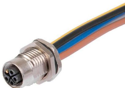
Вашим периферийным устройствам требуется питание большей мощности. С нашим новым вставным разъемом M12 можно обеспечить питание более 250 В и 2 А без всяких проблем. Компактные вставные разъемы M12 с A-, K-, L-, S- и T-кодировкой предназначены для передачи напряжения до 630 В перем. тока или 60 В пост. тока при силе тока до 12 А.
