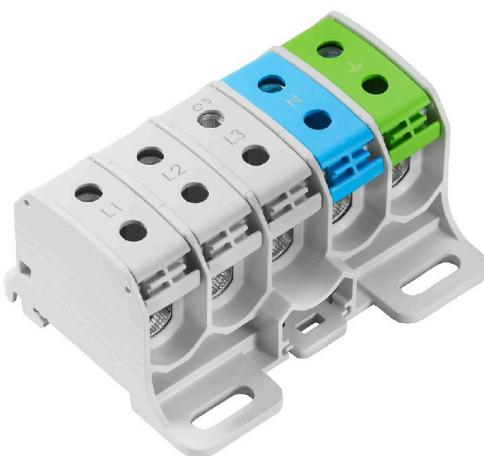
Входные силовые клеммные колодки типа WPD серии Klippon® обеспечивают простое и безопасное присоединение алюминиевых и медных проводников на небольшой площади. При желании/необходимости можно использовать также подключения, нужные для подачи электропитания и присоединения систем мониторинга. Применение заказчиками входных силовых клеммных колодок типа WPD никак не ограничено материалом проводника. Их можно устанавливать напрямую или на DIN-рейку TS35.
