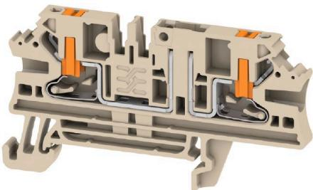
В некоторых случаях применения имеет смысл добавить тестовое гнездо или элемент отключения в проходную клемму для проверки и обеспечения безопасности. С помощью измерительно-расцепительных клемм вы измеряете электрические цепи в отсутствие напряжения. В то время как путь тока утечки и воздушный зазор не измеряются, должно быть доказано указанное номинальное импульсное напряжение.
