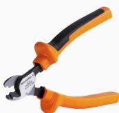
Режущие инструменты для проводников наружным диаметром до 8, 12, 14 и 22 мм. Особая геометрия лезвия обеспечивает резку медных и алюминиевых проводников без перекатия и с минимальным физическим усилием. Режущие инструменты (от KT 8 до KT 22) также поставляются с защитной изоляцией до 1000 В, прошедшей испытания VDE и GS, в соответствии со стандартом EN/ IEC 60900.
