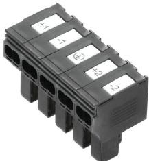
Распределение электроэнергии с использованием необработанных кабелей сечением от 1,5 до 6 мм<sup>2</sup>. Подача электропитания/Т-образный отвод посредством соединения PUSH IN (0,5-10 мм<sup>2</sup>) и/или вставное соединение (0,5-4 мм<sup>2</sup>). Цветная маркировка обеспечивает четкое распределение проводов.
