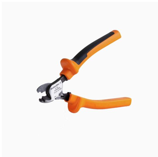
Режущие инструменты для проводников наружным диаметром до 8, 12, 14 и 22 мм. Особая геометрия лезвия обеспечивает резку медных и алюминиевых проводников без пережата и с минимальным физическим усилием. Режущие инструменты (от КТ 8 до КТ 22) также поставляются с защитной изоляцией до 1000 В, прошедшей испытания VDE и GS, в соответствии со стандартом EN/ IEC 60900.
