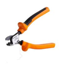
Режущие инструменты для проводников наружным диаметром до 8, 12, 14 и 22 мм. Особая геометрия лезвия обеспечивает резку медных и алюминиевых проводников без пережатия и с минимальным физическим усилием. Режущие инструменты (от КТ 8 до КТ 22) также поставляются с защитной изоляцией до 1000 В, прошедшей испытания VDE и GS, в соответствии со стандартом EN/ IEC 60900.
