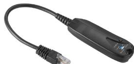
Модуль для сохранения и загрузки конфигурации устройств
