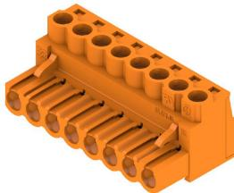
Гнездовой разъем с винтовой системой с зажимным хомутом для подключения проводов с прямым (180°) направлением выводов. Гнездовые разъемы обеспечивают место для маркировки и допускают кодирование. Крепление осуществляется с помощью фланца или фиксатора. Кроме того, они оснащены встроенным винтом с двумя шлицами (прямым и крестообразным), защитой от неправильной вставки провода и поставляются с открытыми зажимными хомутами. HC = сильноточный.
