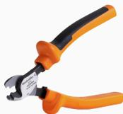
Режущие инструменты для проводников наружным диаметром до 8, 12, 14 и 22 мм. Особая геометрия лезвия обеспечивает резку медных и алюминиевых проводников без пережатия и с минимальным физическим усилием. Режущие инструменты (от KT 8 до KT 22) также поставляются с защитной изоляцией до 1000 В, прошедшей испытания VDE и GS, в соответствии со стандартом EN/ IEC 60900.
