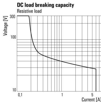
Кривая предельной нагрузки
