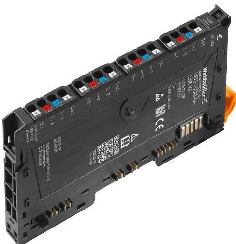
Цифровой счетчик и коммуникационные модули 100/500 кГц; 32-разрядный счетчик; диагностика состояния отдельных каналов Кодовые датчики положения (инкрементные и абсолютного значения) стали незаменимыми в современных автоматизированных системах.
