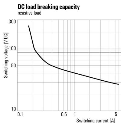
Кривая предельной нагрузки
