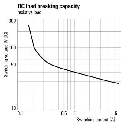
Кривая предельной нагрузки
