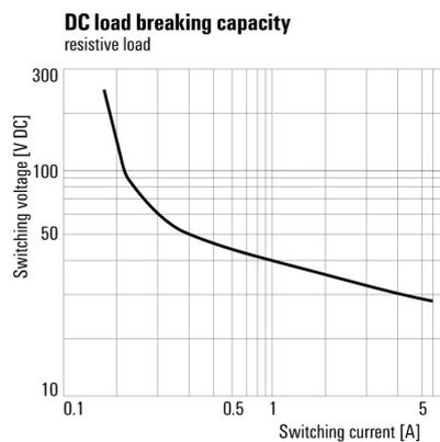
Кривая предельной нагрузки
