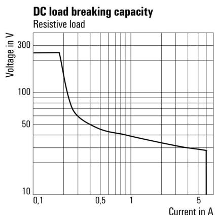
Кривая предельной нагрузки
