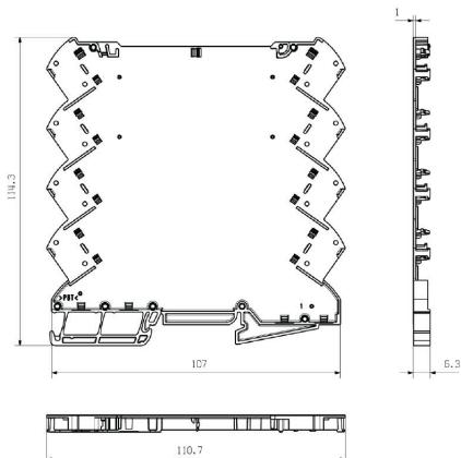
Базовый элемент без выреза в нижней части
