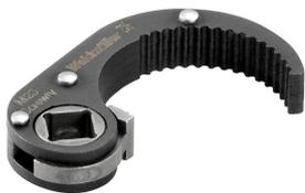
Принадлежность Screwty® подходит для цилиндрических вставных разъемов M23 (для сборки заказчиком) и литых с повторным формованием цилиндрических вставных разъемов M23 с наружным размером гайки с накаткой  $26,2 \pm 0,3$  мм. Момент затяжки составляет 2–2,5 Нм.
