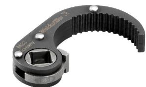
Принадлежность Screwty® подходит для цилиндрических вставных разъемов M23 (для сборки заказчиком) и литых с повторным формированием цилиндрических вставных разъемов M23 с наружным размером гайки с накаткой  $26,2 \pm 0,3$  мм. Момент затяжки составляет 2–2,5 Нм.
