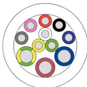
$3 \times 0,75 \text{ mm}^2 + 8 \times 0,34 \text{ mm}^2$
