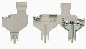
Компонентный штекер служит для интеграции электрического компонента в расцепляющий клеммный блок. После пайки электронного компонента вставку можно интегрировать в расцепляющую зону расцепляющих клеммных блоков, тем самым преобразуя расцепляющий клеммный блок в модульный клеммный блок с интегрированным электронным компонентом.
