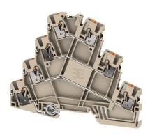
Передача мощности, сигналов и данных является классическим требованием в электротехнике и изготовлении шкафов. Изоляционный материал, технология подключения и конструкция клемм являются отличительными особенностями. Проходная клемма подходит для объединения и/или соединения одного или нескольких проводников. В ней может присутствовать один или несколько уровней соединения с одинаковыми потенциалами и изоляцией друг от друга.
