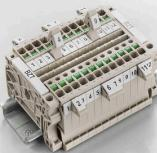
Держатель маркировочных элементов обеспечивает возможность дополнительной установки стандартных маркеров с шагом 5 или 5,1 мм. Угловые держатели могут быть дополнительно комбинированы и установлены во всех маркировочных каналах модульных клеммных колодок Klippon®. Типы установочных маркеров можно найти под соответствующими принадлежностями специального держателя маркировочных элементов.
