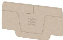
Концевые пластины крепятся к открытой стороне последней клеммы перед концевым стопором. Благодаря использованию концевой пластины обеспечивается работоспособность клеммы и заданное расчетное напряжение. Гарантируется защита от прикосновения к деталям, находящимся под напряжением, и таким образом клеммы безопасны для прикосновения.
