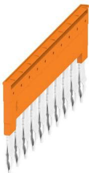
Распределение или умножение потенциала среди смежных клеммных блоков реализуется через перемычку. Это позволяет избежать дополнительных усилий при монтаже. Надежность контакта в клеммных блоках гарантирована даже при разветвлении полюсов. В нашем ассортименте представлены вставные и привинчиваемые винтовые системы перемычек для модульных клеммных блоков.
