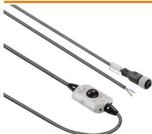
Датчик движения для осветительных приборов WIL-LED с винтовым соединением, с сетевым кабелем 3 м и кабелем M12 для подключения к лампе WIL. Время переключения может регулироваться.
